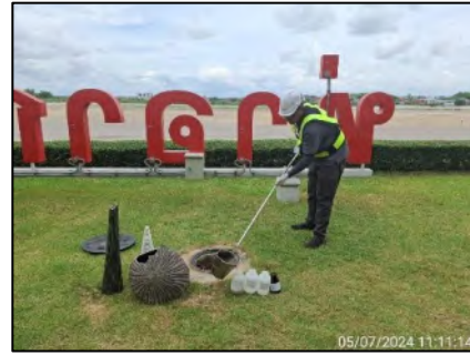
บ่อกักน้ำทิ้งก่อนผ่านระบบบำบัดน้ำเสียของอาคารที่พักผู้โดยสาร ขาเข้า
